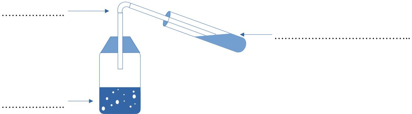
On peut recueillir un gaz grâce à la technique du déplacement d'eau schématisée ici.
