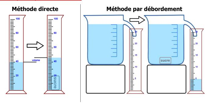
**Remarque** : La méthode par débordement permet d'utiliser une éprouvette qui possède une sous division plus petite (éprouvette plus petite), ce qui permet de réaliser <u>une mesure plus précise</u> !
